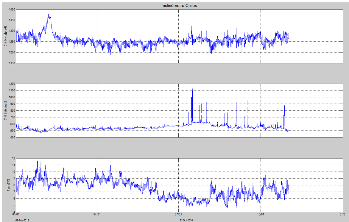
Figura 67. Componentes de inclinación Norte y Este, registro de temperatura del inclinómetro electrónico Chiles, instalado en el volcán del mismo nombre, para el periodo comprendido entre el 1 de enero y el 31 de octubre de 2016.
